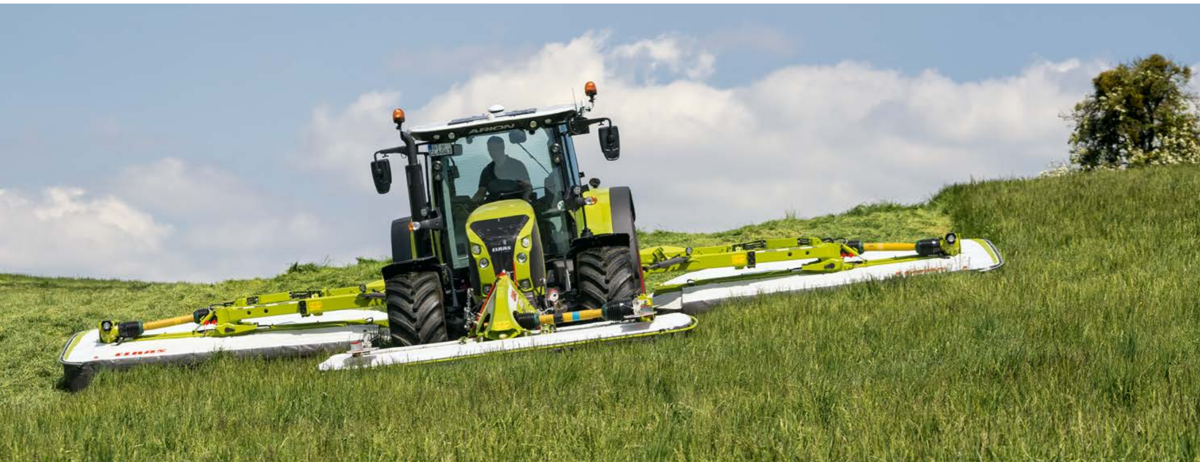
Para DISCO 1100 TREND se ofrece una práctica unidad de mando para la elevación individual, el plegue a la posición de transporte y, opcionalmente, para encender y apagar los focos de trabajo.
