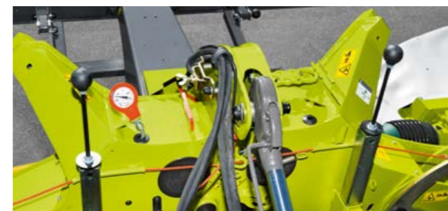
Manómetro para el fácil ajuste de la presión de apoyo para las dos unidades segadoras.
